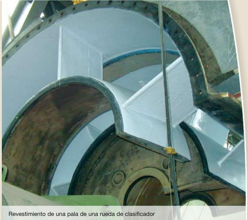
Revestimiento de una pala de una rueda de clasificador
